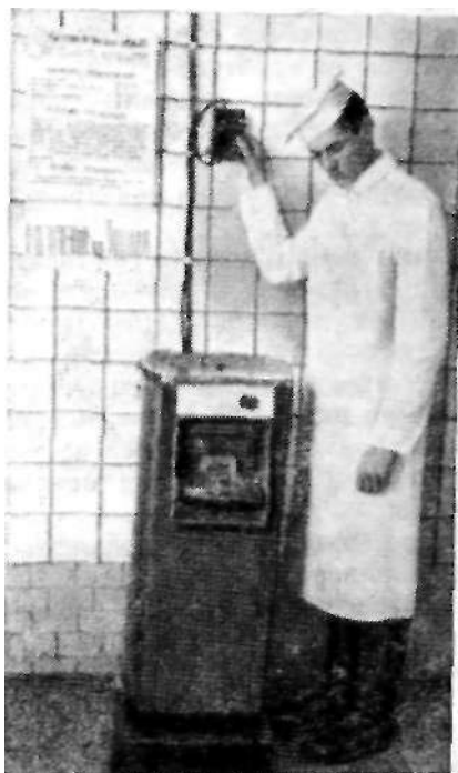
Рис. 1. Защита токоведущих частей технологического оборудования
