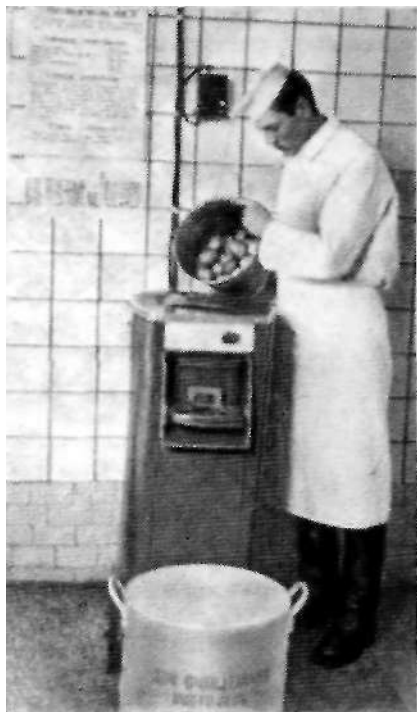
Рис. 13. Очистка картофеля в механической картофелечистке
