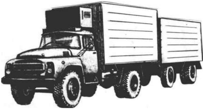
Рис. 2.1. Автомобіль-рефрижератор ЛуМЗ-890Б і причіп-рефрижератор ЛуМЗ-853Б з холодильною установкою на зовнішній стороні передньої стінки кузова
